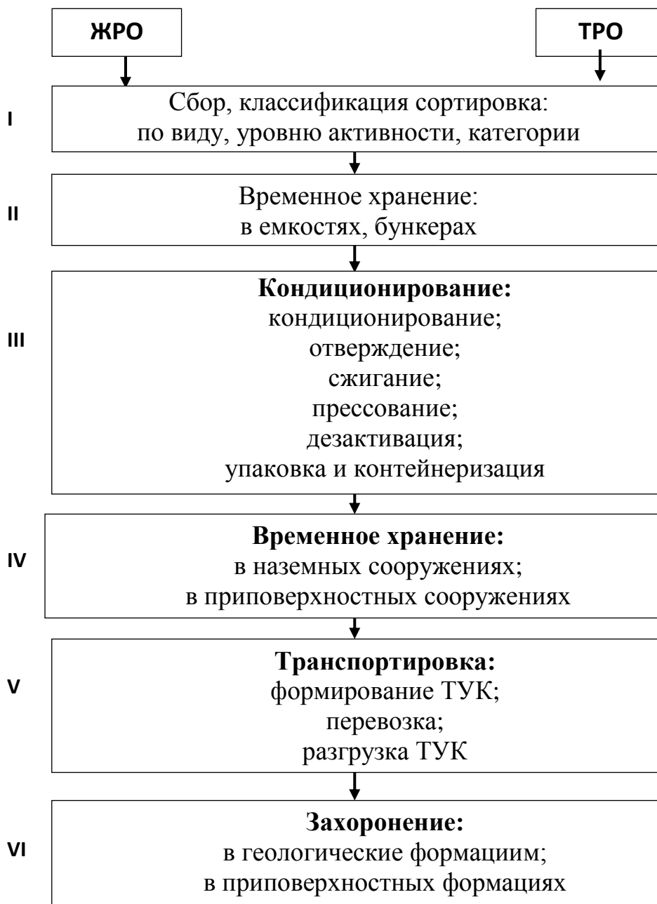
Рис. 5.17. Концепция обращения с жидкими и твердыми радиоактивными отходами (Энергетика в цифрах и фактах // Бюллетень ЦОИ, № 4, 1992)
