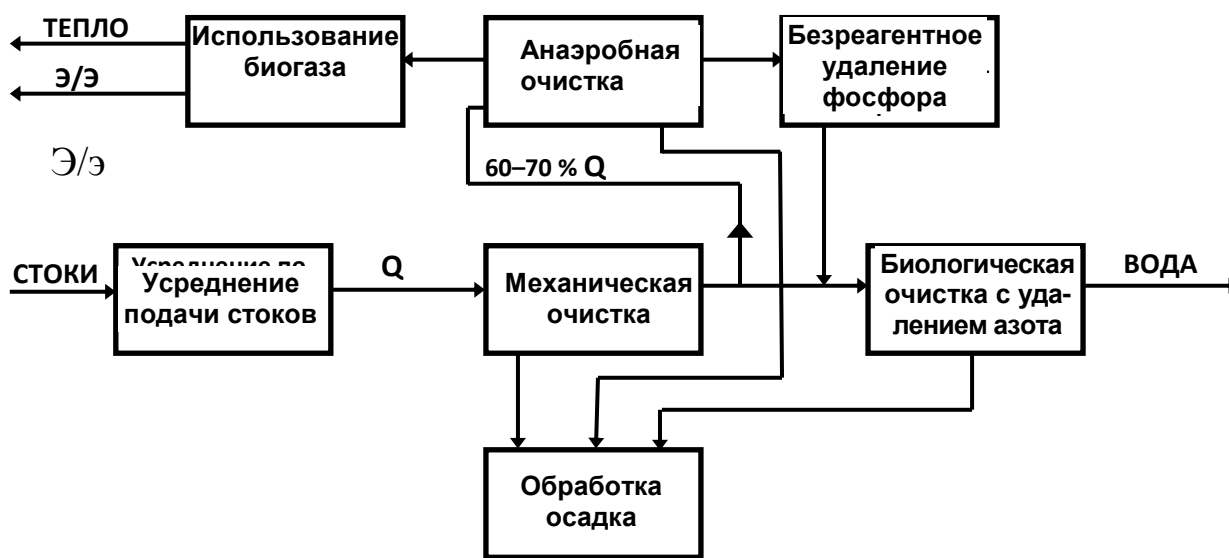
Рис. 8.1. Основные этапы очистки сточных вод свиного комплекса «Надеево»
