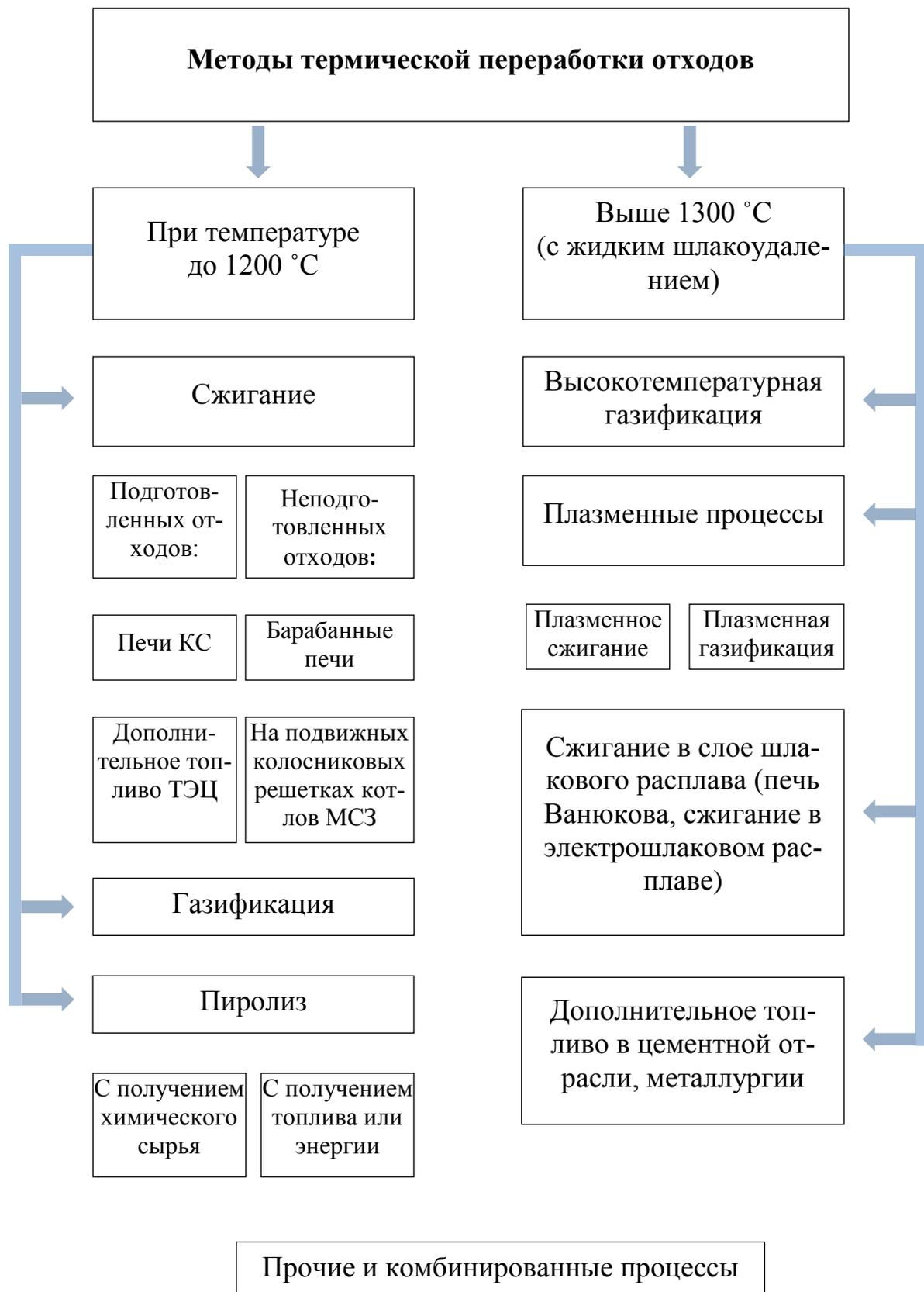
Рис. 3.11. Классификация термических методов переработки отходов
