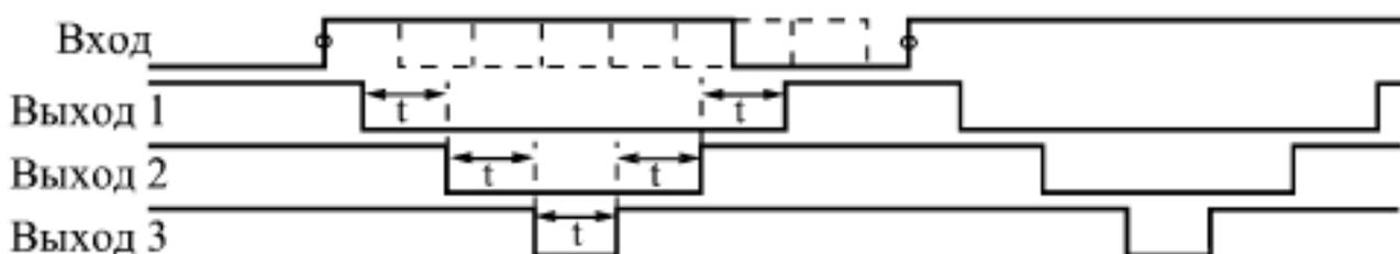
Рис. 14. Диаграмма работы проектируемого микропрограммного автомата
