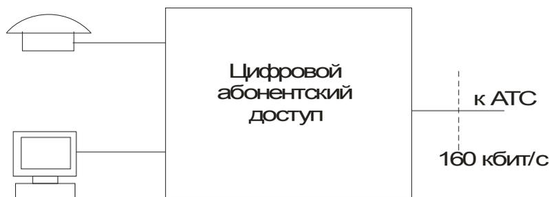
Рисунок 14.5 – Схема подключения абонентов при базовом доступе
