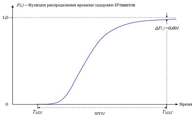
Рисунок 11.3 – Функция распределения задержки IP пакетов
