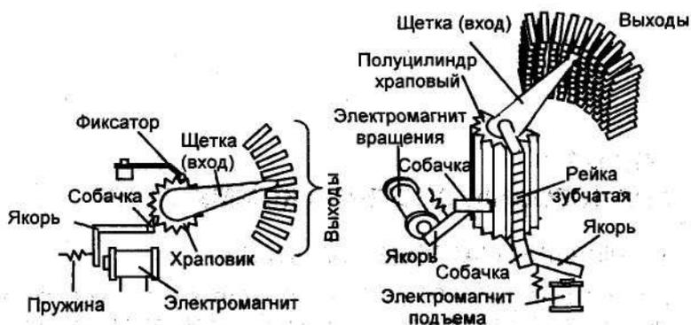
Рис. 8.1. Устройство шагового искателя Рис. 8.2. Устройство декадно-шагового искателя
