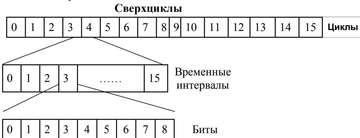
Рисунок 8.11 - Цикловая структура пятнадцатиканальной системы ИКМ
