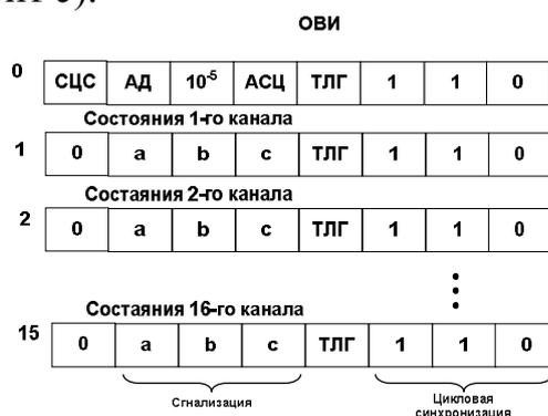
Рисунок 8.12- Передача сигнальной информации по 1ВСК в системе ИКМ-15
