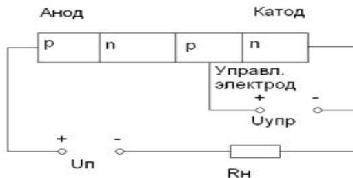
Рис. 12. Схема подключения и структура тиристора
