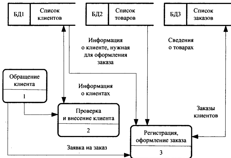
Рис. 2.11. Пример построения диаграммы потоков данных
