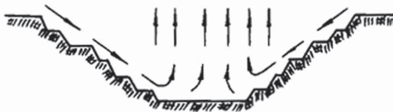
23.3-сурет. Тұйық контурымен карьердегі ауа алмасудың инверсиялы сұлбасы
