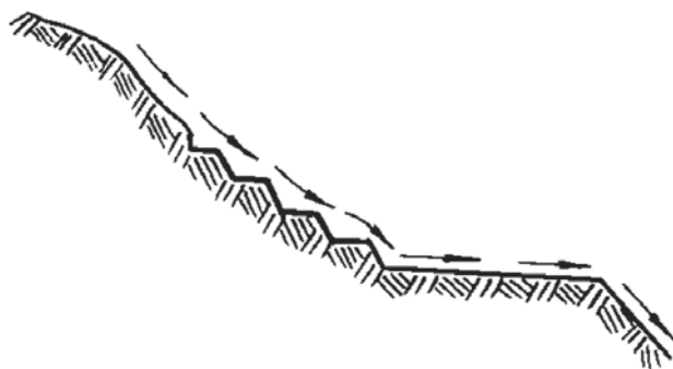
23.4-сурет. Тұйық шекарасыз тау беткейлеріндегі карьерлердегі инверсиялы ауа алмасу сұлбасы
