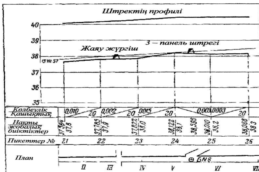
69-сурет. Қазбадағы темір жолдың рельсінің профилі
