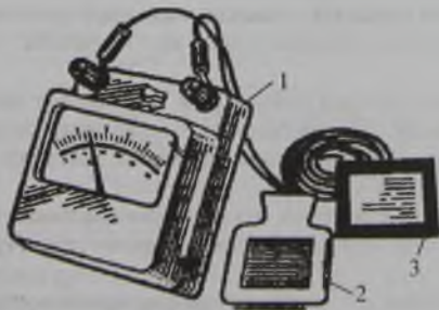
1-сурет. Фотоэлектрлік люксметр Ю-16 1 – гальванометр; 2 – фотоэлемент; 3 – сүзгі
