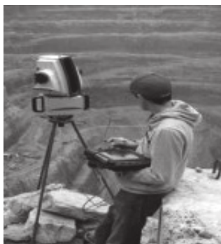
4.5-сурет. Тұрақты пунктке орнатылған лазерлі сканер, сканерлеу және планшеттегі скандарды тексеру
