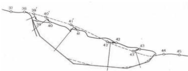
4.4-сурет. Маркшейдерлік аспаптық бақылаулар нәтижесінде сырғу сызығының орнын анықтау схемасы
