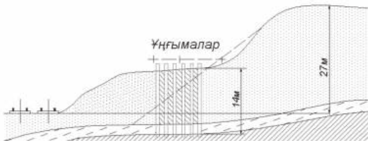
4.15-сурет. Карьер беткейі тау жыныстарын тұрақты электр өрісімен нығайтудың схемасы
