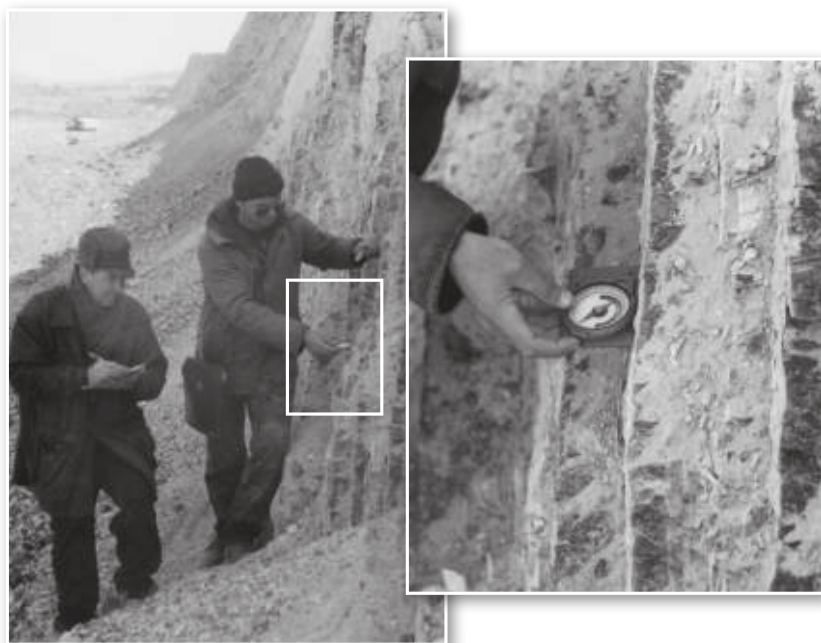
3.10-сурет. Карьерде массивтің жарықшақтылығын түсіру
