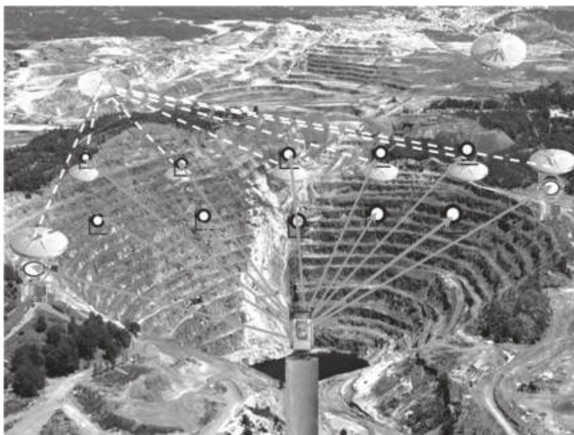
4.7-сурет. Карьердегі GPS құрылымдарының схемасы
