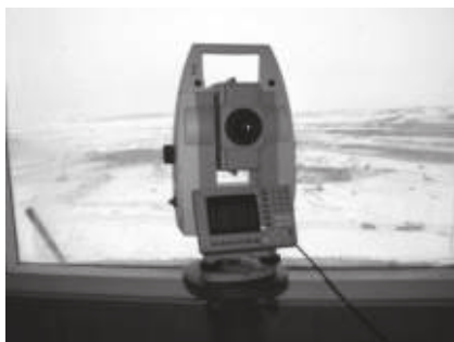
4.9-сурет. Васильков карьеріндегі автоматтандырылған бақылау а – бақылау күркесі; ә – аспаптық бағана және компьютерлік стол
