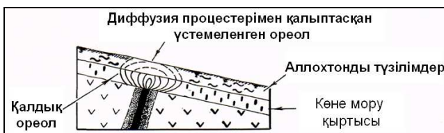
9.2-сурет. Үстемеленген ореолдың қалыптасу схемасы
