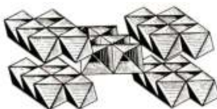
202-сурет. Диаспордың полигов полиэдрлеріндегі кристалдық құрылымы
