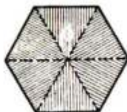
331-сурет. Слюда заңы бойынша үшем кірікпесі
