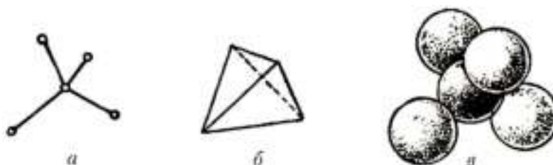
82-сурет. Атомдардың тетраэдрлік орналасуын бейнелеудің түрлі тәсілдері. Атомдар центрлері аралығының қашықтығы барлық үш фигурада бірдей.
