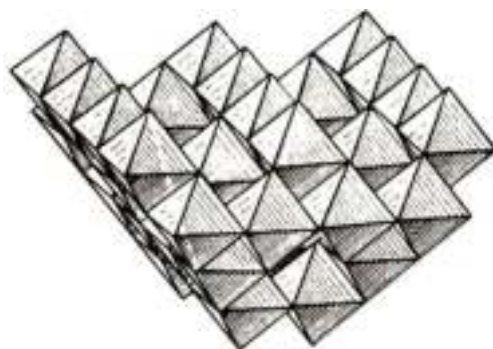
151-сурет. Шпинельдің кристалдық құрылымы. Октаэдрлерден тұратын құрылымның негізгі мотиві тік төрттік ось бойынша тұрғызылған (Н.В. Белов бойынша)
