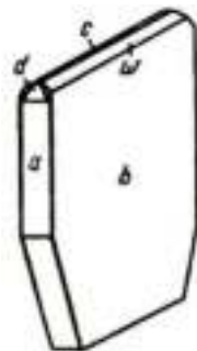
201-сурет. Лепидокрокит кристалы: a\{100\} , b\{010\} , c\{001\} , d\{201\} , w\{031\}
