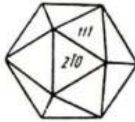
124-сурет. Кобальтин кристалы: пентагондодокаэдр мен октаэдрдің комбинациясы
