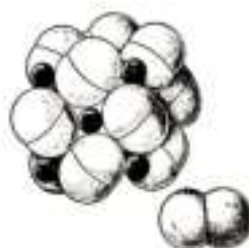
115-сурет. Пириттің кристалдық құрылымы: кара сфералар – \text{Fe}^{2+} иондары; ақшылдар – [\text{S}_2]^{2-} топтары
