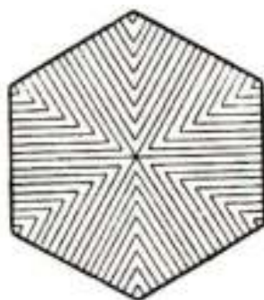
113-сурет. Молибденит кристалының базалық жағындағы штрихтердің үш жүйесі
