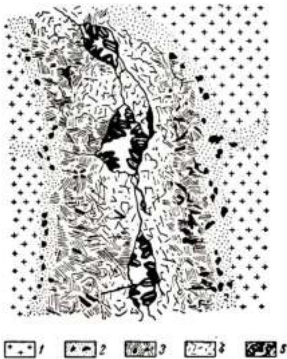
53-сурет. Мурзинка пегматит желісінің (Ортаңғы Орал) құрылысы (А.Е. Ферсман бойынша): 1 – гранит; 2 – аплит зонасы; 3 – графикалық зона («жазба гранит»); 4 – далашпат пен кварцтың алып кристалды массалары; 5 – «қуышық» (кристалдар друзалары бар қуыстар)
