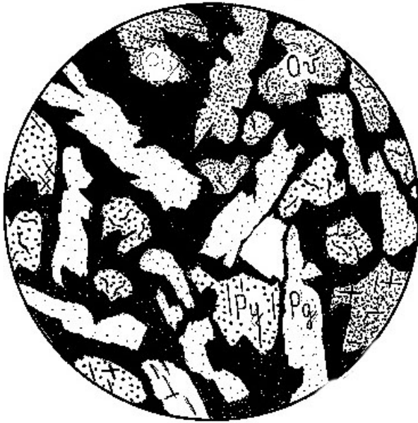
78- сурет. Оливинді долериттің құрылымы сақталған боксит; гиббсит плагиоклаз, пироксен, оливинді алмастырады, қара - темірдің гидроксидтері.
