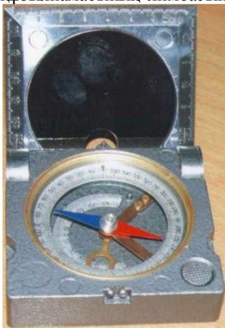
25-сурет. Тау-кен құбылнамасы. 1 – пластинка; 2 – лимб; 3 – клинометр; 4 – клинометрді бекітуші винт; 5 – тілшік; 6 – шыны; 7 – арретир; 8 – жартылай лимб.
