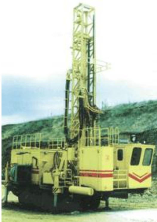
1.18 а-сурет. СБШ-160/200-40 шарқашаулы карьерлі станогы
