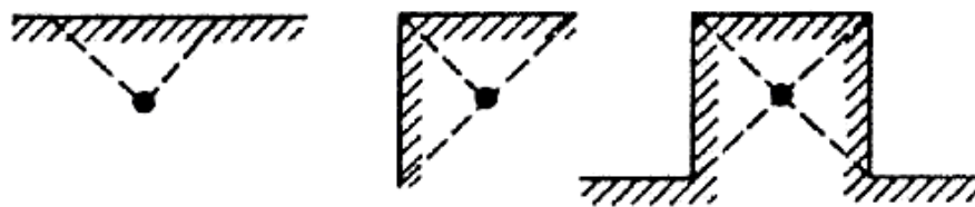
5.4-сурет. Ашық кеңістіктер санының өсуіне байланысты жарылыстың қопарғыштық әсерінің жоғарылауы
