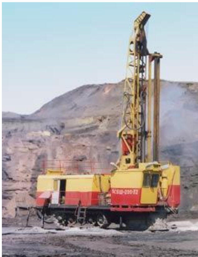
1.18 а-сурет. 6СБШ-200-32 шарқашаулы карьерлі станогы
