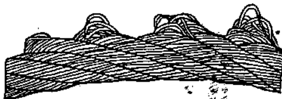
6.47-сурет. Өрім сымдарының итеріліп ығыстырылып шығарылуы: а – бір өрімде; б – бірнеше өрімде
