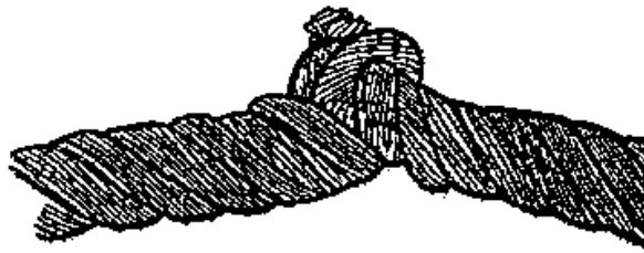
6.49-сурет. Метал өзекшесінің шығып қалуы
