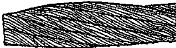
6.43-сурет. Органикалық өзекшенің бұзылуындағы арқан диаметрінің жергілікті кішіреюі
