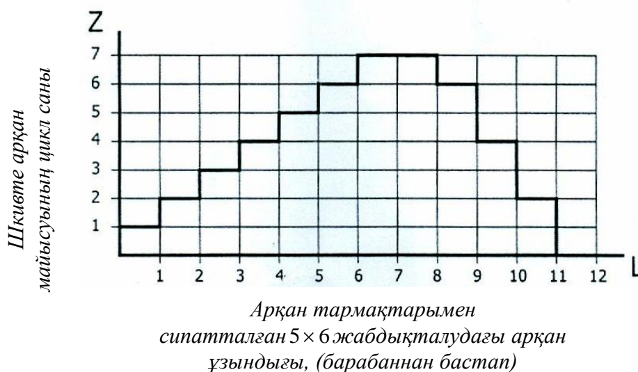
1.10-сурет. Тәл блогының свеча биіктігіне көтеру кезінде шкивтерде және барабанда арқан майысу цикл санының таралу сұлбасы
