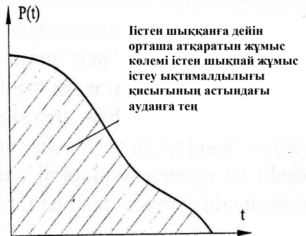
4.2-сурет. Істен шыққанға дейінгі атқаратын жұмыс көлемінің геометриялық мағынасы
