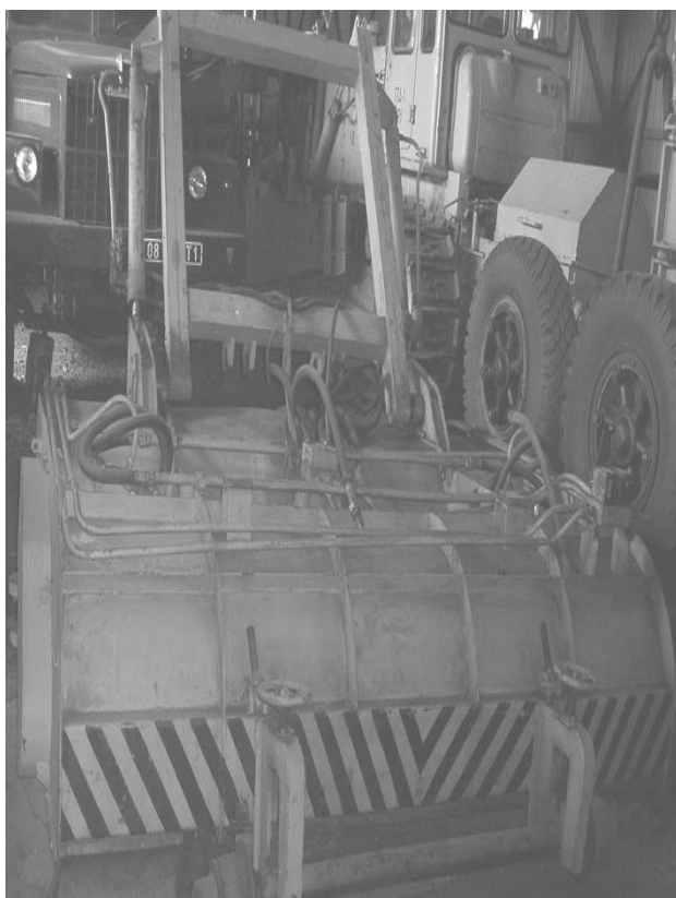
8.1-сурет. Кенорындарында ауалы-сулы ағындармен шаңды басу құрылғысы УМП-1
