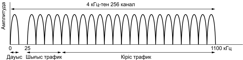
2.30-сурет. Дискретті мультитонды модуляцияны қолдану арқылы ADSL жұмысы
