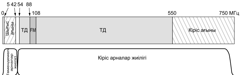
2.46-сурет. Интернетке қол жеткізу үшін қолданылатын әдеттегі кабельдік теледидар жүйесіндегі жиілікті тарату
