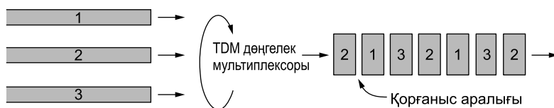
2.23-сурет. Уақытты тарату негізінде мультиплекстеу (TDM)
