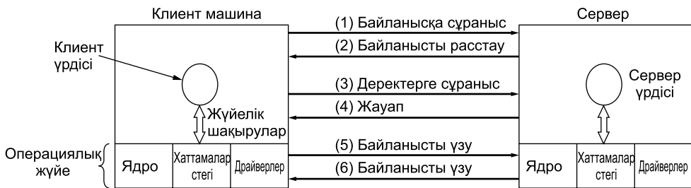
1.15-сурет. Клиент пен сервердің жалпықабылданған дейтаграммалардың негізіндегі қарапайым қарым-қатынасы
