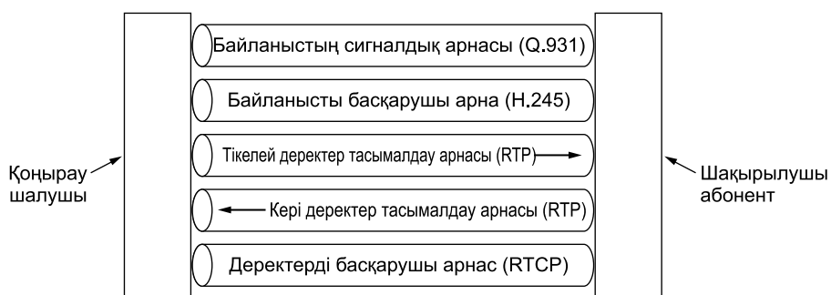
7.35-сурет. Сөйлесу кезіндегі қоңырау шалушы және шақырылушы абоненттер арасындағы логикалық арналар
