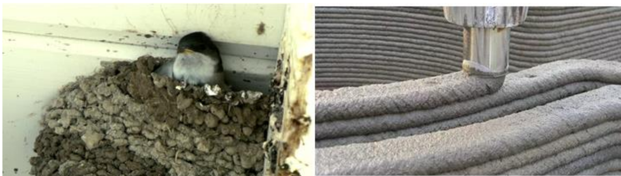
Рисунок 1 – Схожесть строения: слева – видны слои гнезда, справа – наносимые слои бетона
