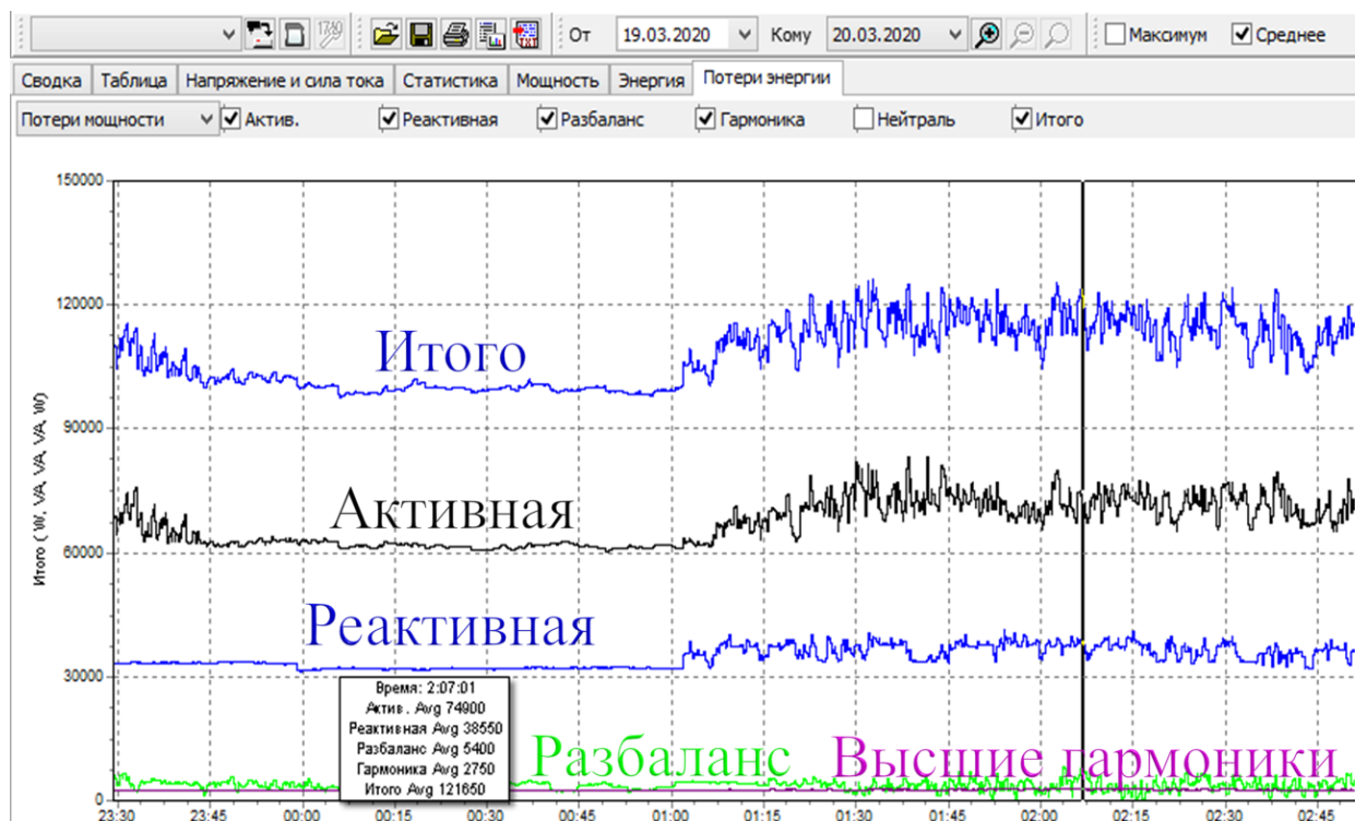
Рисунок 7 – Профили потерь мощности на электрическом вводе
