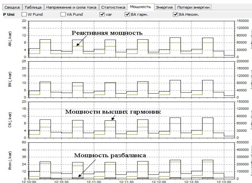
Рисунок 2 – Спектр идентифицированных мощностей Мощность никуда не исчезает, но отрицательную мощность нельзя извлечь
