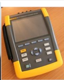
Анализатор энергии и качества электроснабжения Fluke 435
