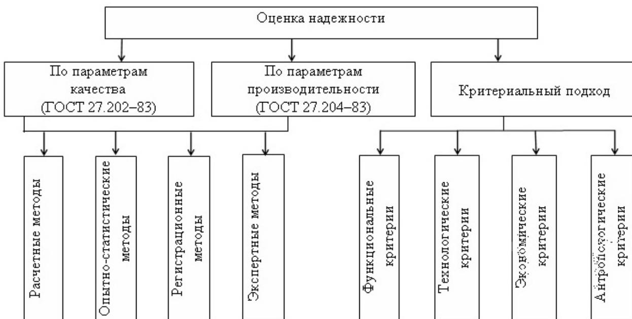
Рисунок 4 - Подходы к определению надежности технологических систем
