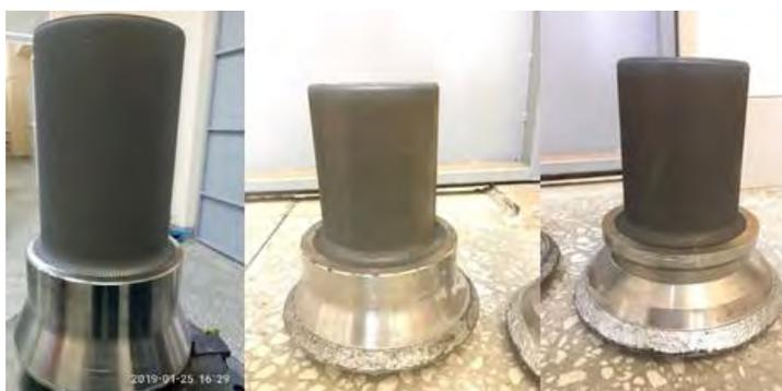
Рисунок 10 - Готовое покрытие шеек прокатных валков
