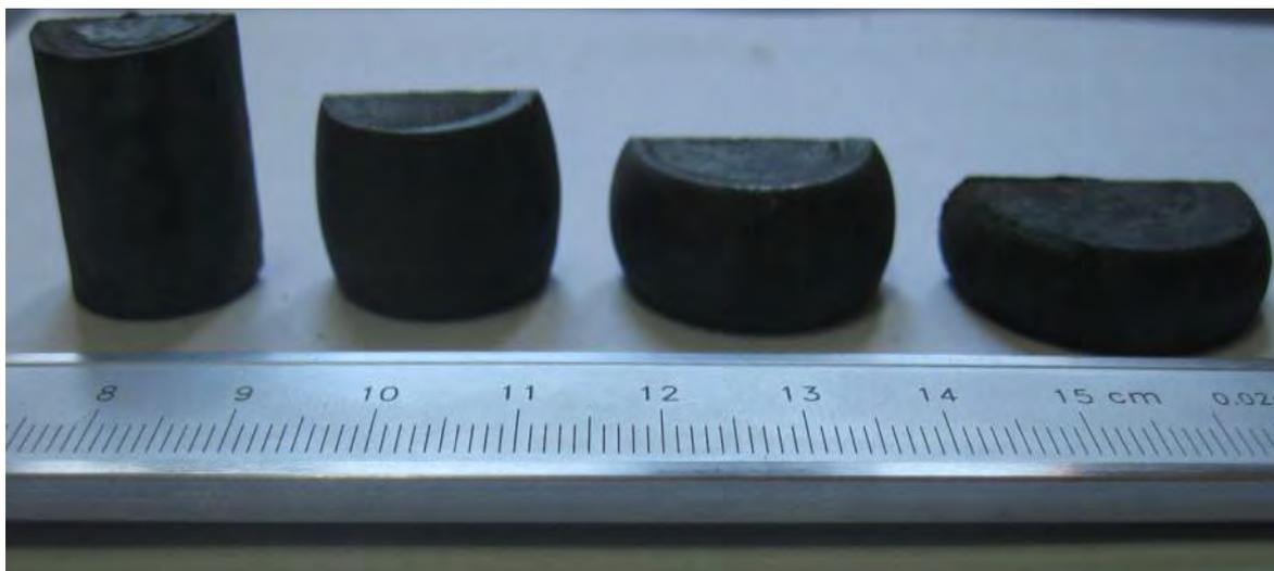
Рисунок 1 - Общий вид цилиндрических образцов после осадки
