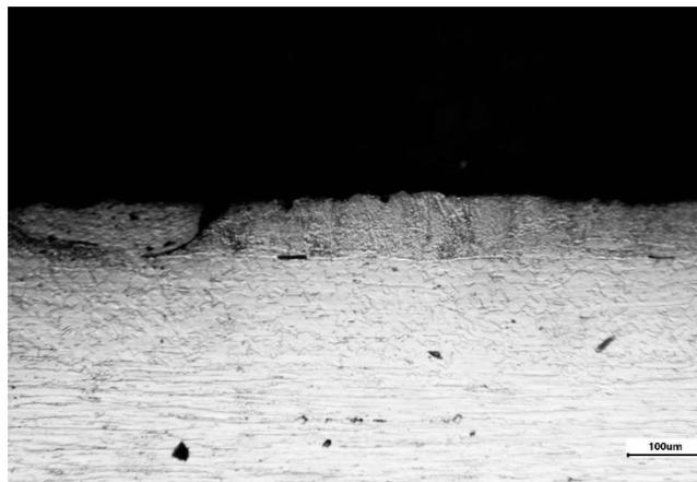
Рисунок 3 - Растекающийся по поверхности наплавленный слой (x100)
