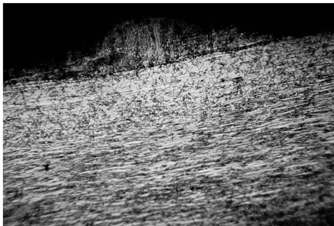
Рисунок 2 - Капельное формирование поверхности наплавленного слоя (x100)
