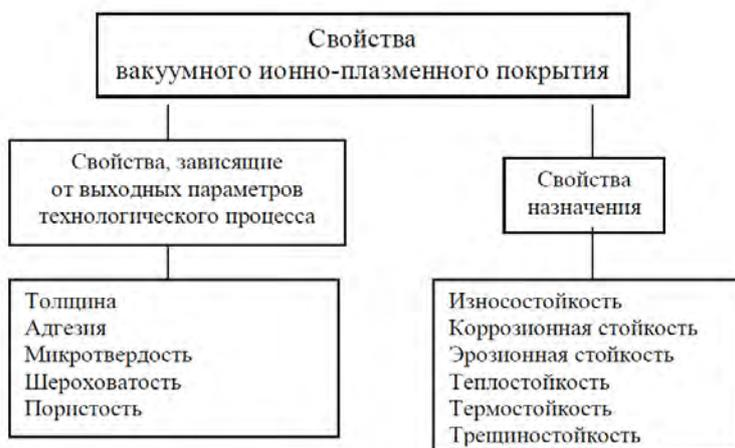
Рисунок 3 - Классификация свойств вакуумного ионно-плазменного покрытия, основанная на функциональных связях в системе «изделие – покрытие»
