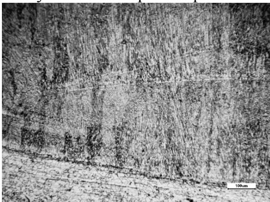
Рисунок 5 - Микроструктура наплавленного слоя (x100)
