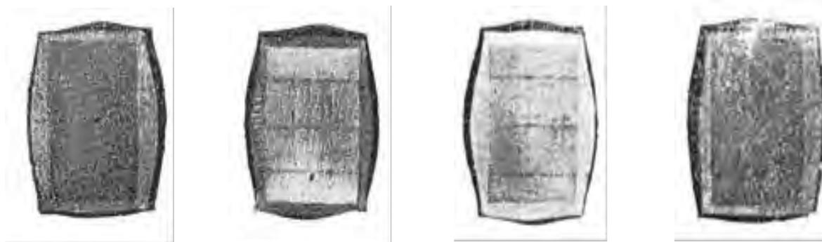
Рисунок 1 - Прямоугольные образцы из свинца, меди, алюминия, стали (слева направо) после осадки
