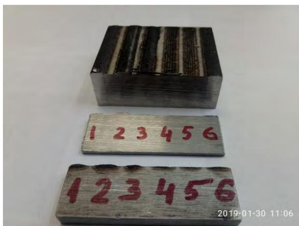
Рисунок 1 - Внешний вид наплавленных валиков
