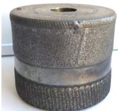
Рисунок 9 - Цилиндрический образец после наплавки
