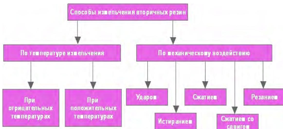
Рисунок 1 – Способы измельчения шин
