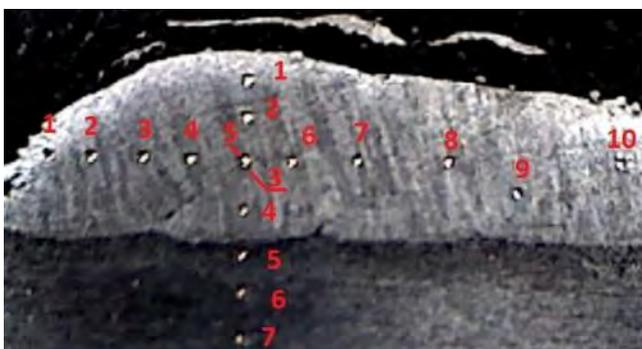
Рисунок 7 - Схема измерения микротвердости (x50)
