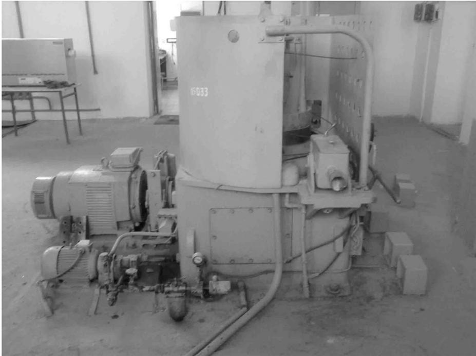
Рисунок 3 – Общий вид волочильного стана В-1/550М
