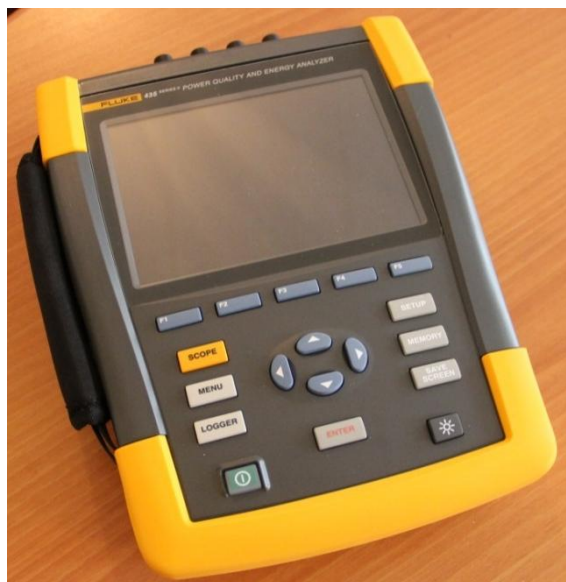
Рисунок 3.8 – Внешний вид 3-х фазного анализатора качества электрической энергии FLUKE 430 СЕРИИ II
