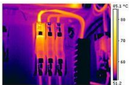
Рисунок 4.13 - Поиск перегрева электроцепей
