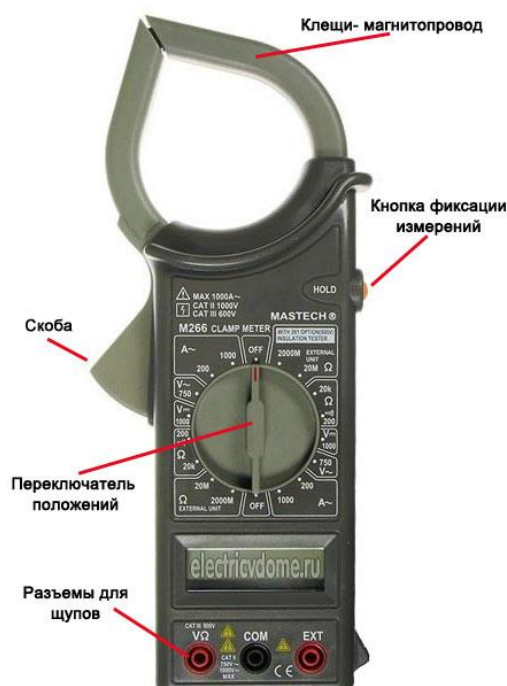
Рисунок 3.3 - Конструкция и обозначения токоизмерительных клещей
