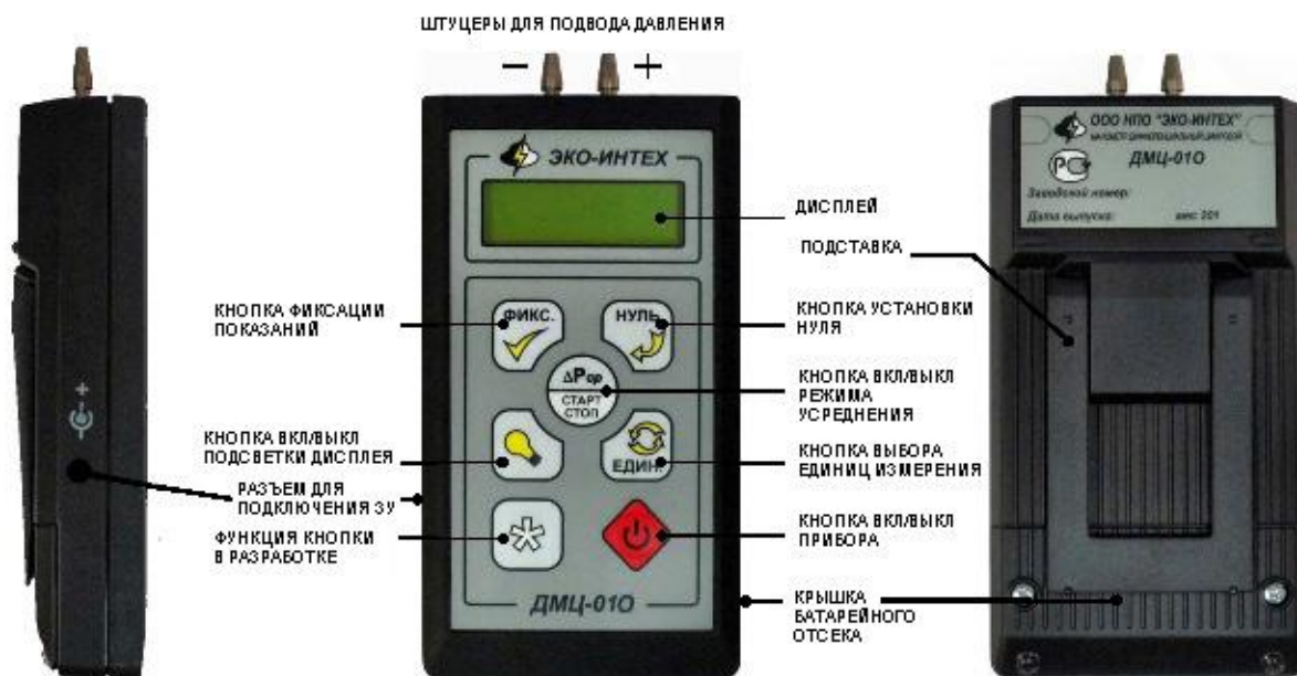
Рисунок 3.5 - Дифференциальный манометр принцип действия
