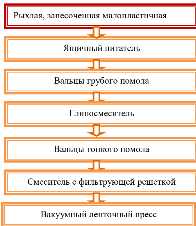
Рисунок 25 – Подготовка рыхлого глинистого сырья
