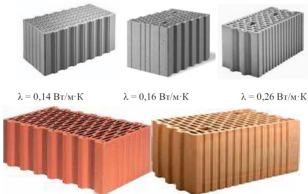
Рисунок 11 – Крупноформатные многопустотные керамические блоки
