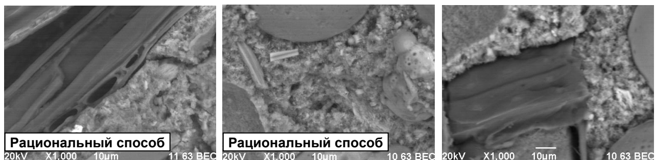
Рисунок 1.32 – Микроструктура сульфомагнезиальных композитов различного приготовления
