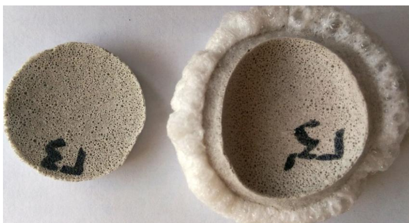
Рисунок 2.15 – Внешний вид щелочесиликатного материала с микросферой до вспучивания (слева) и после вспучивания (справа)
