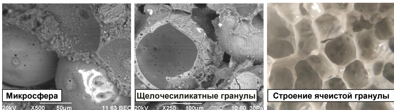
Рисунок 2.12 – Микроструктура жидкостекольной композиции с пористыми частицами
