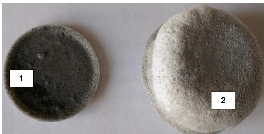
Рисунок 2.13 – Внешний вид щелочесиликатного материала до (1) и после (2) вспучивания
