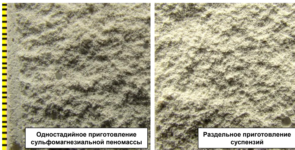
Рисунок 1.9 – Структура сульфомагнезиального пенобетона различного приготовления
