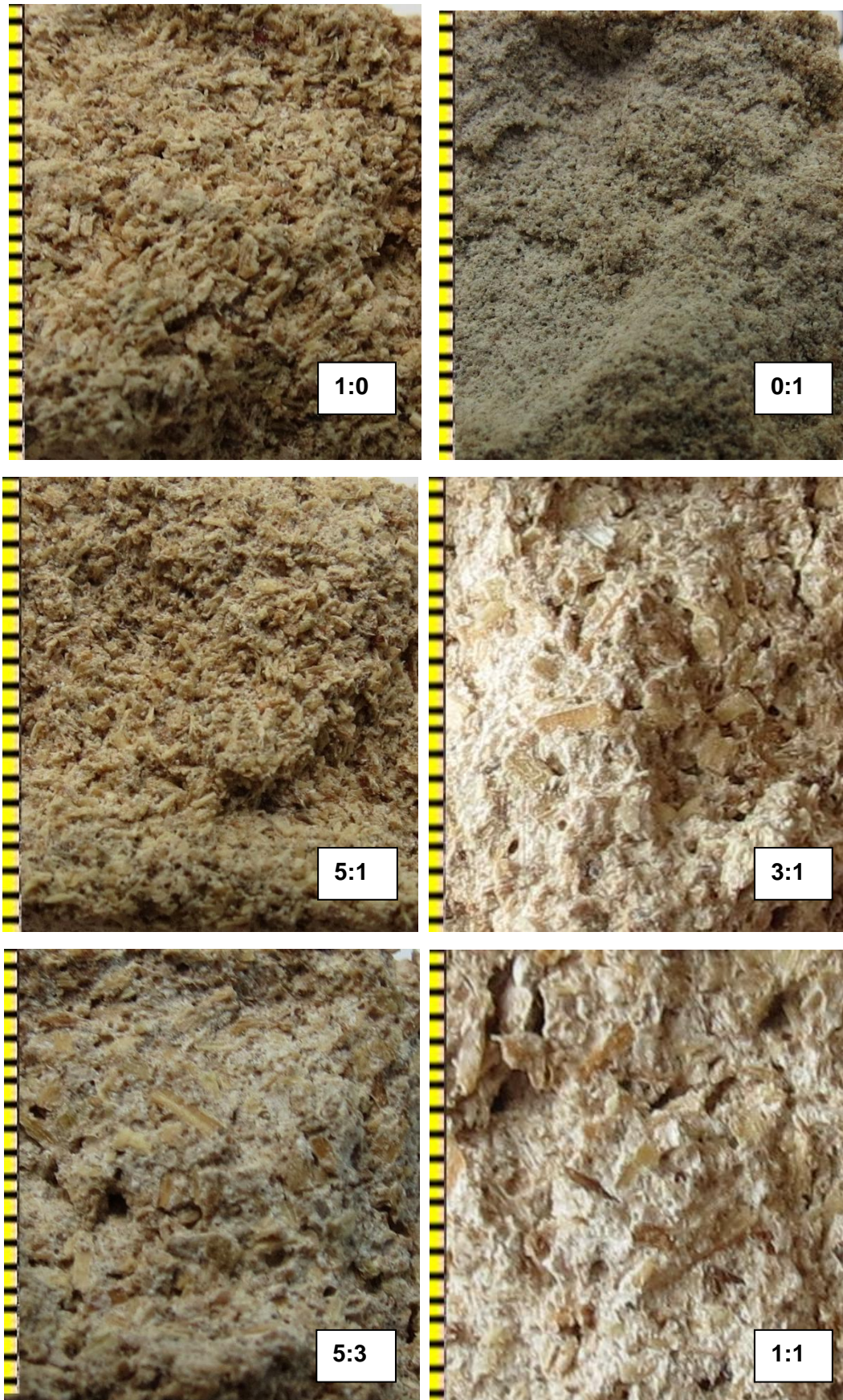
Рисунок 1.20 – Структура композитов с различным соотношением «опилки : микросфера»
