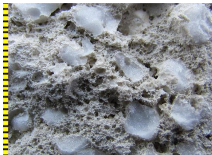
Рисунок 1.17 – Структура магнезиального композита комплексной поризации
