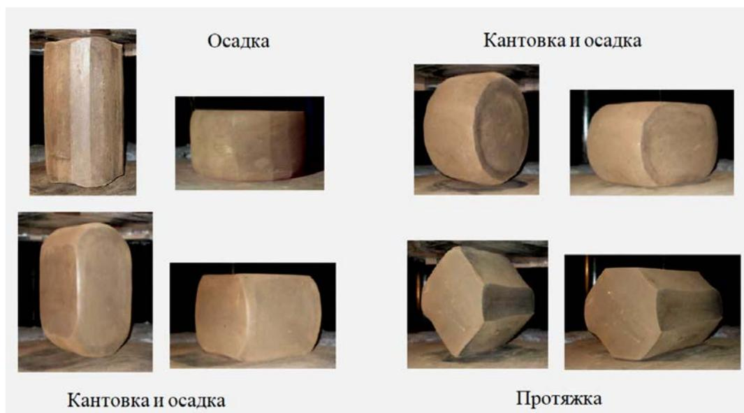
Рисунок 1.14 - Схема выполнения одного этапа открытойковки [33]
