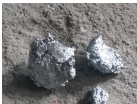
Рисунок 5.19 - Внешний вид разрушенных образцов при нагреве в печи
