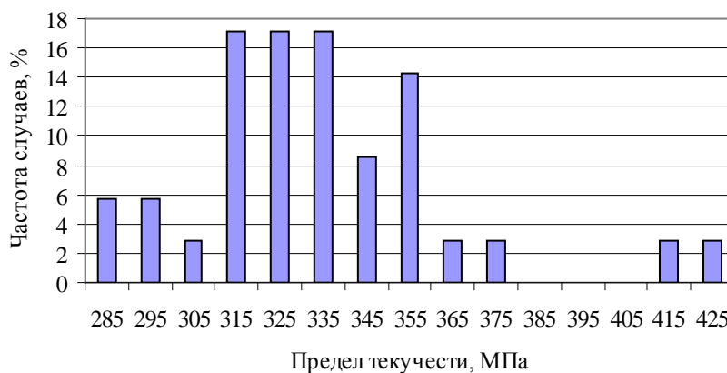
Рисунок 5.5 – Гистограмма распределения \sigma_T листа толщиной от 6,0 до 8,0 мм из катаного металла
