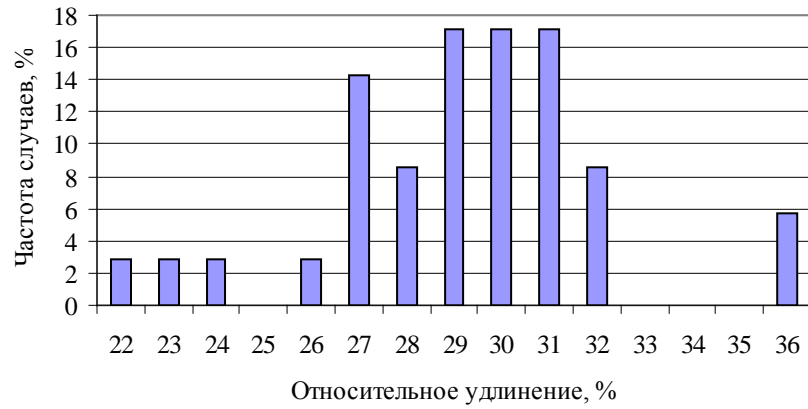
Рисунок 5.7 – Гистограмма распределения \delta листа толщиной от 6,0 до 8,0 мм из катаного металла
