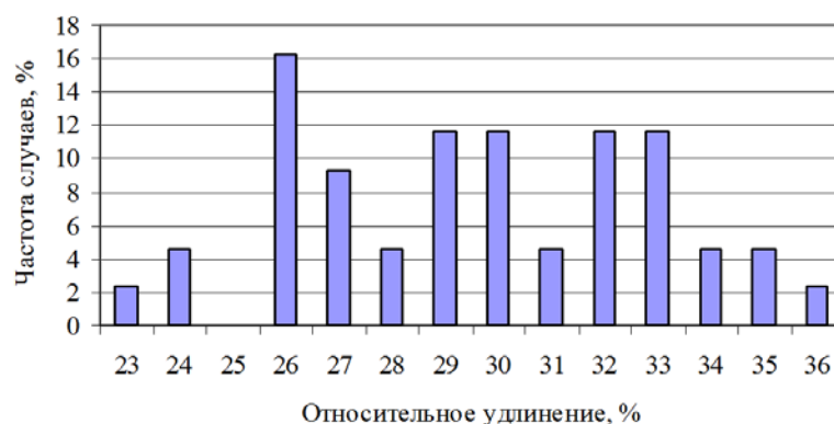
Рисунок 5.16 – Гистограмма распределения \delta листа толщиной более 8,0 мм из непрерывнолитого металла
