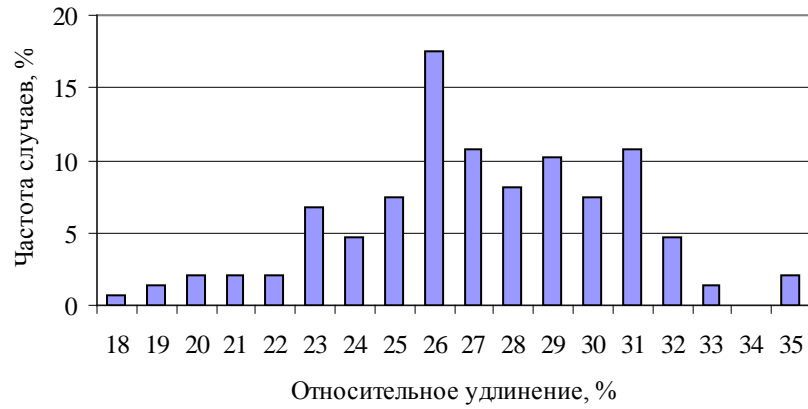
Рисунок 5.13 – Гистограмма распределения \delta листа толщиной более 8,0 мм из катаного металла
