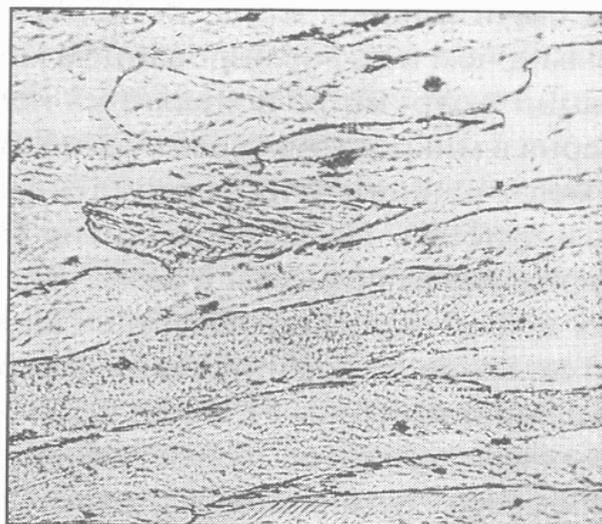
Рисунок 4.3 – Микроструктура технического железа после деформации по степени обжатия 60%  $\times 340$
