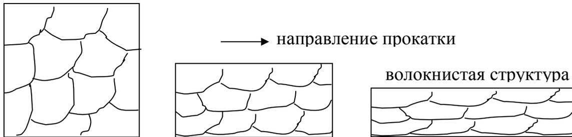
Рисунок 43 – Схема изменения структуры
