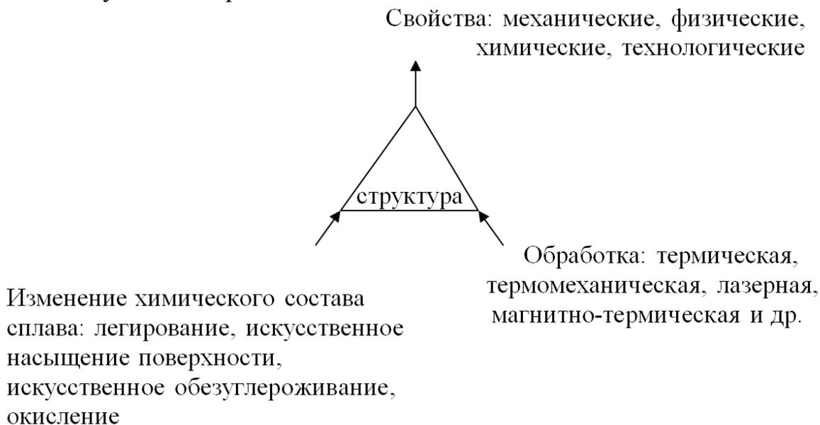
Рисунок 23 – Сущность термической обработки
