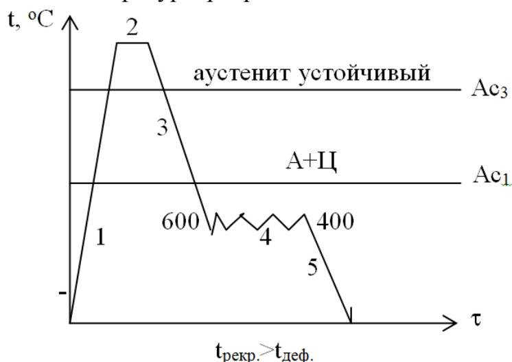
1- нагрев под прокатку; 2 – выдержка для получения однородного аустенита; 3 – подстуживание на воздухе; 4 – пластическая деформация; 5 - закалка
