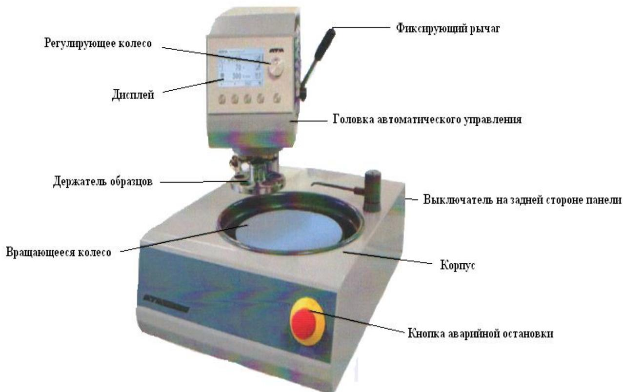
Рисунок 2.1 - Шлифовально-полировальный станок Saphir 520
