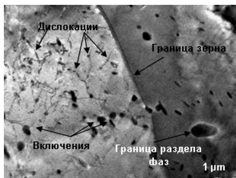
Рис. 7.21. ПЭМ. Изображение дефектов отожженного алюминиевого образца (дислокации, границы зерна и раздела фаз, включения) [11]
