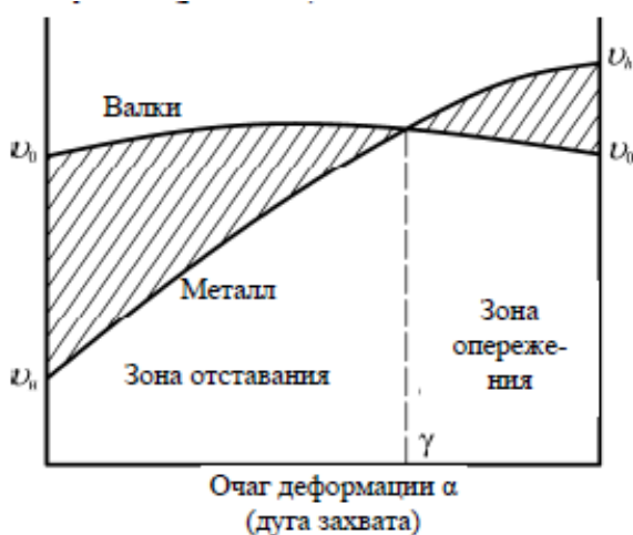
Рис. 16.5. Изменение скорости металла и валков в очаге деформации при прокатке
