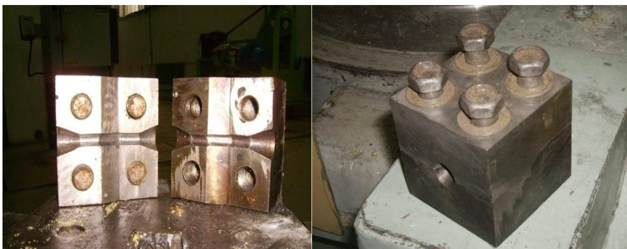
Рисунок 4.4 – Изготовленная равноканальная ступенчатая матрица
