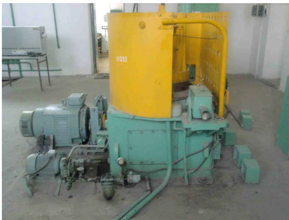
Рисунок 4.1 – Общий вид волочильного стана
